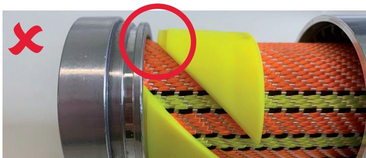
Der Absatz des Innenrings **muss** vor dem Pressvorgang komplett von Hand in den Stutzen formschlüssig eingeschoben werden (s. rechte Abbildung).
