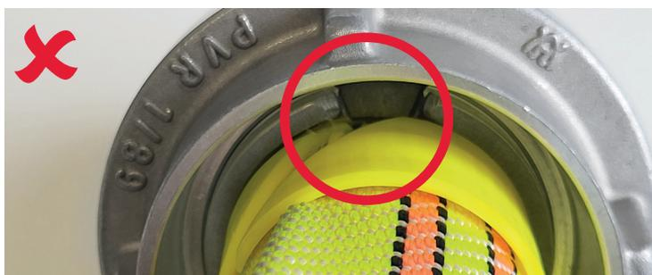
Die Nut des Innenrings darf **nicht** auf gleicher Höhe der Aussparung um den Stutzen liegen.
