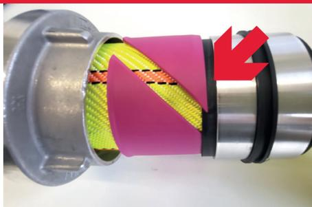
Der Außenring muss von Hand an dem Innenring angesetzt werden.
