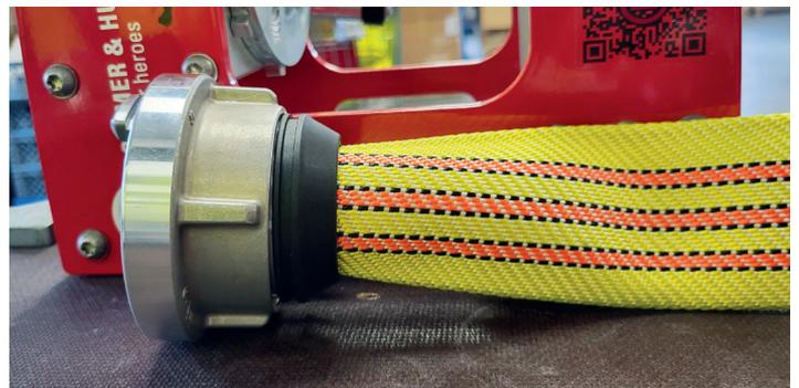
Nach Verpressung -> Prüfung gemäß den Sicherheitshinweisen. Die Demontage des GH EASY-FIX-Systems erfolgt in umgekehrter Reihenfolge.
