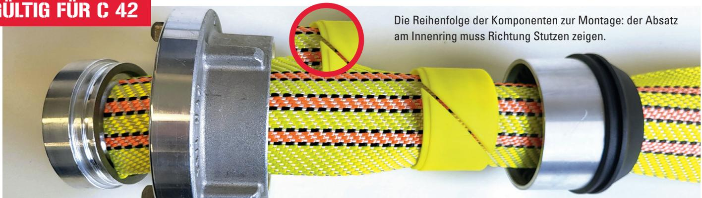
Die Reihenfolge der Komponenten zur Montage: der Absatz am Innenring muss Richtung Stutzen zeigen.
