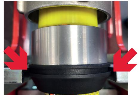
Die Nut des Außenrings muss formschlüssig in das Montagegerät eingesetzt werden.
